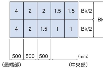
●断続配置間隔(1m)の雪圧係数
